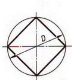
Разделить окружность на 4 и 8 равных частей
