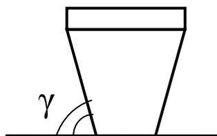
Рисунок 2 - Угол наклона бункера
