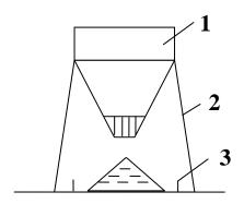
1-воронка, 2 - стойка (тренога), 3 - металлический лист Рисунок 3 - Установка для определения угла естественного откоса материала.
