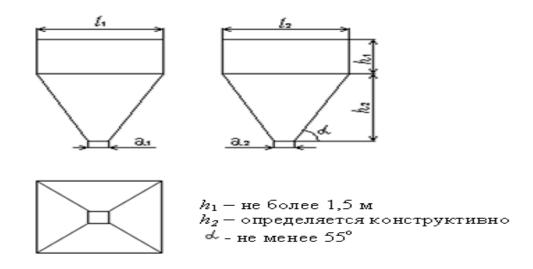
Рисунок 1- Комбинированный бункер
