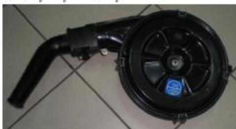
**Рис. 1. Воздушный фильтр автомобиля**
