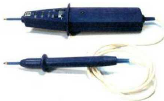
Рисунок 4.3 - Указатель напряжения комбинированный УНК-04
