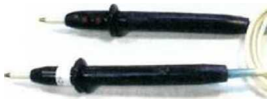
Рисунок 4.2 - Двухполюсный указатель низкого напряжения
