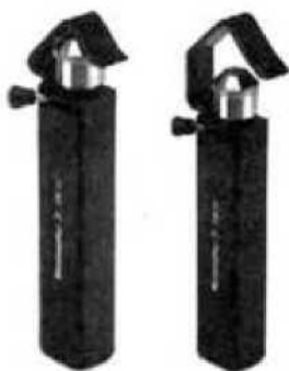
Рисунок 4.12 - Инструмент для снятия ПВХ-изоляции с кабеля круглого сечения
