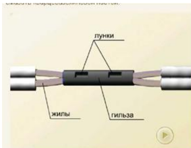
Рисунок 7.1 - Способ соединения опрессовкой.
