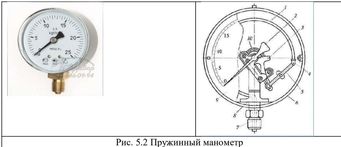
Рис. 5.2 Пружинный манометр
