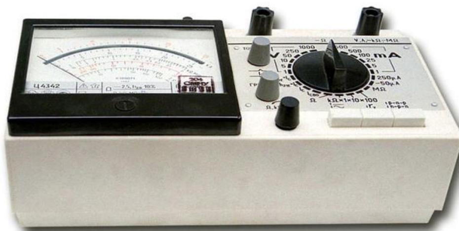
Прибор электроизмерительный комбинированный Ц4342 (далее прибор) с автоматической защитой от электрических перегрузок предназначен для измерения силы и напряжения постоянного тока, действующего значения силы и напряжения переменного тока синусоидальной формы, сопротивления постоянному току, параметров транзисторов мощностью до 150 мВт
