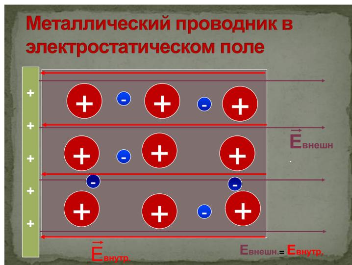
Если проводник поместить во внешнее электрическое поле, то начнется перемещение свободных зарядов таким образом, что положительные заряды скапливаются на одной стороне, а отрицательные - на противоположной. Перераспределение зарядов будет происходить до тех пор, пока поле, созданное этими зарядами, не скомпенсирует внешнее поле. Если в этот момент разделить проводник плоскостью, перпендикулярной внешнему полю, то разделенные части проводника окажутся заряженными разноименно.
