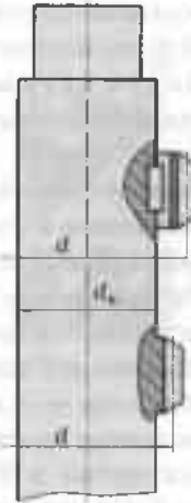
Рис. 1.18. Конструктивное определение диаметра зубчатого колеса
