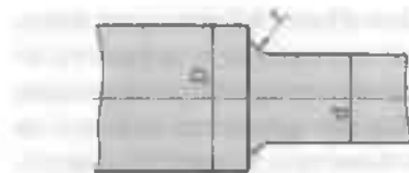
Рис. 1.16. Галтель на валу (оси):
