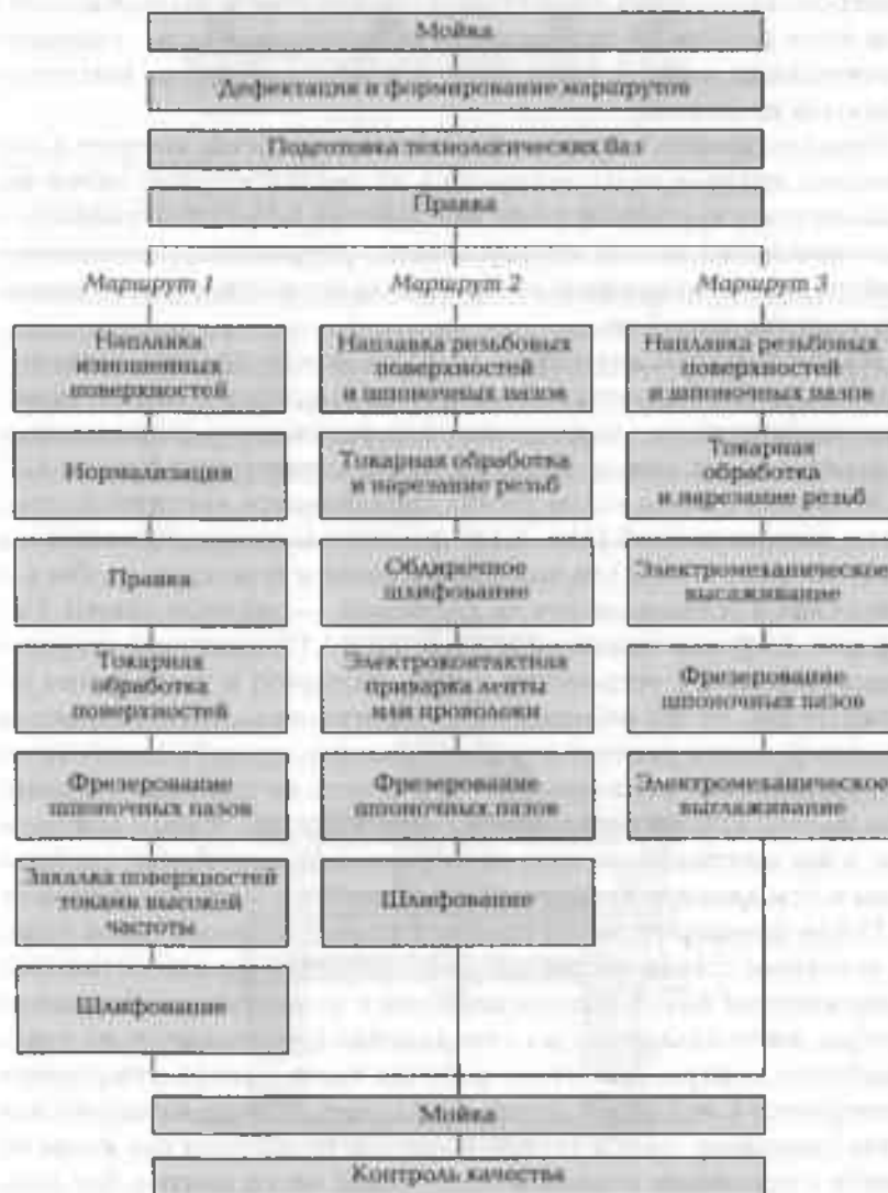
Рис. 1.13. Схема технологического процесса восстановления гладких валов и осей
