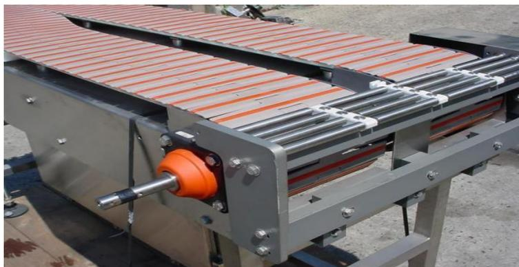
Рисунок 1- Общий вид пластинчатого конвейера
